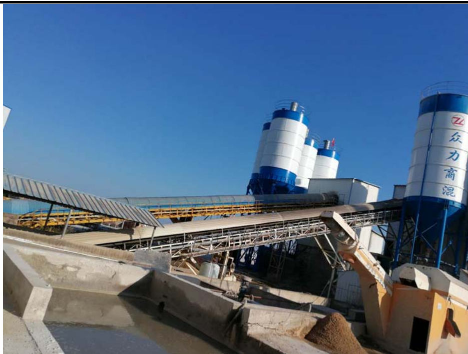
图 3-4 半密闭式（带雨棚）输送皮带
