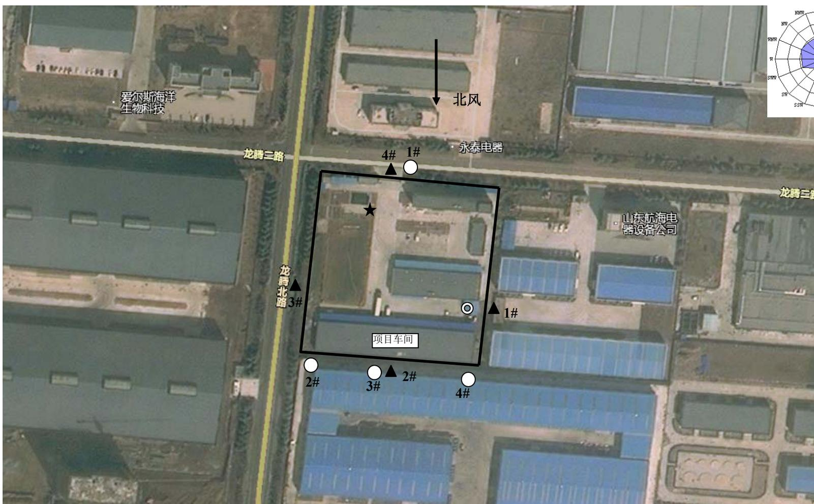
◎ 有组织废气监测点位    ○ 无组织废气监测点位    ▲ 噪声监测点位    ★ 污水监测点位
